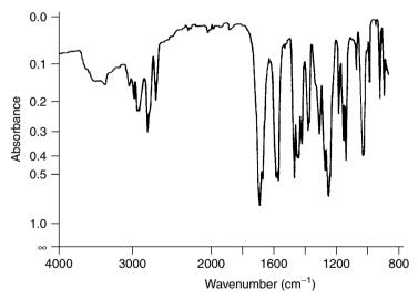
Figure 4.6 Infrared spectrum of 2-methoxybenzaldehyde (cf. DQ 4.1).
